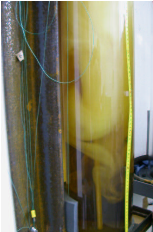
Abb. 4-11: Blasenbildung bzw. Gasaustrag während der Expansion ohne Trennschicht zwischen Stickstoff und Hydrauliköl
