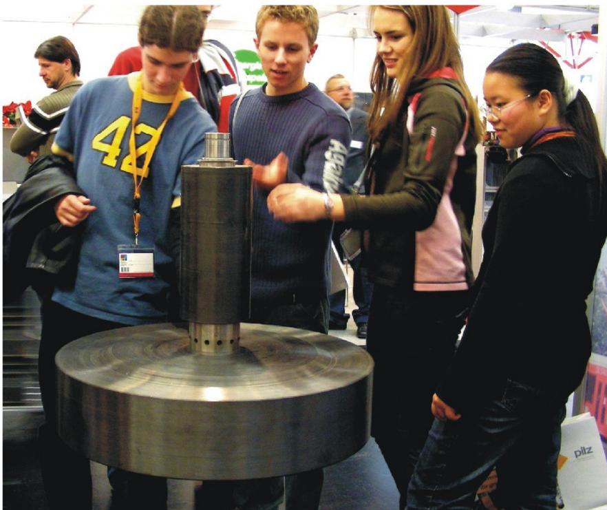
Abb. 2 : Rotor des Schwungrads T2 mit dem Läufer des Elektromotors integriert
