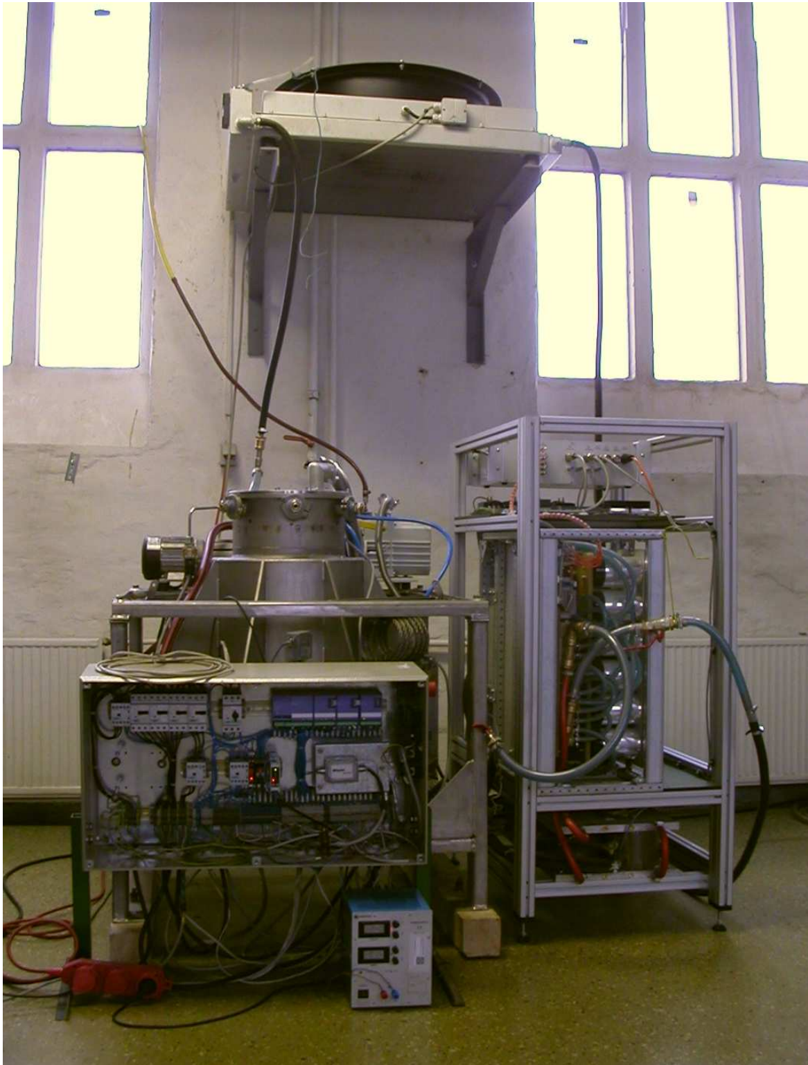
Abbildung 3 : komplettes Schwungradsystem während der Erprobung im Labor
