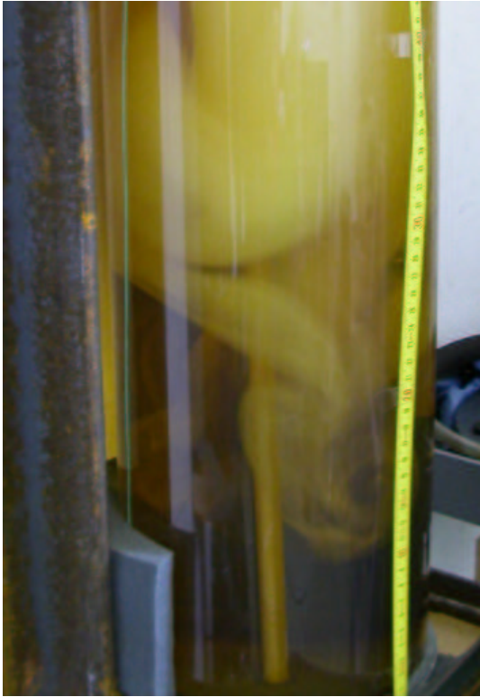
Abbildung 6 : Öl gesättigt mit Stickstoff bei hohem Druck tritt in den Ausgleichsbehälter ein
